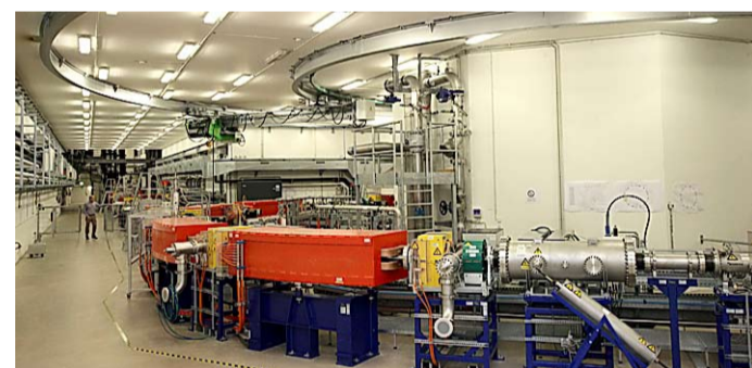
Der Beschleunigerring des Marburger PTZ, auch Synchrotron genannt. Hier erreichen die Ionen Höchstgeschwindigkeit.
